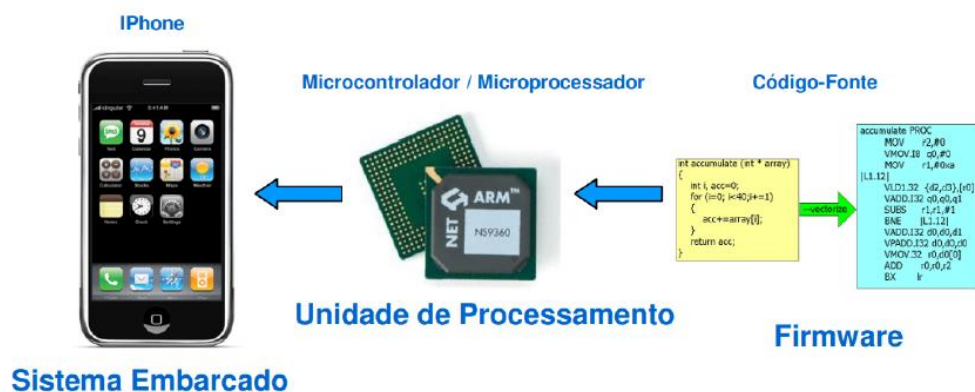
Figura 2 - Lógica de um sistema embarcado microprocessado.
